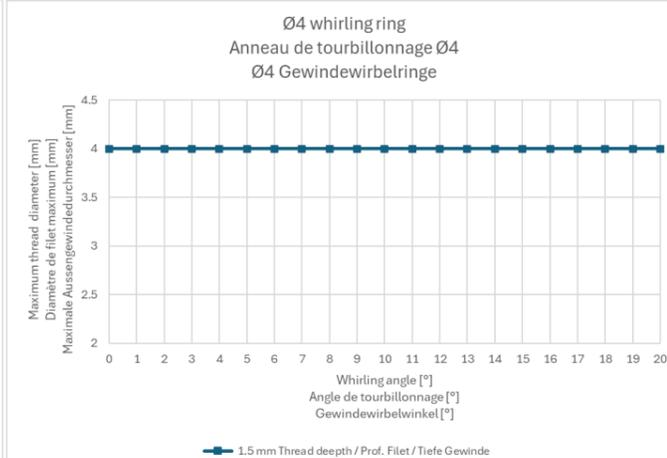
Il n'y a pas de restriction de profondeur du filet et de diamètre pour les support de plaquette de Ø4 mm
