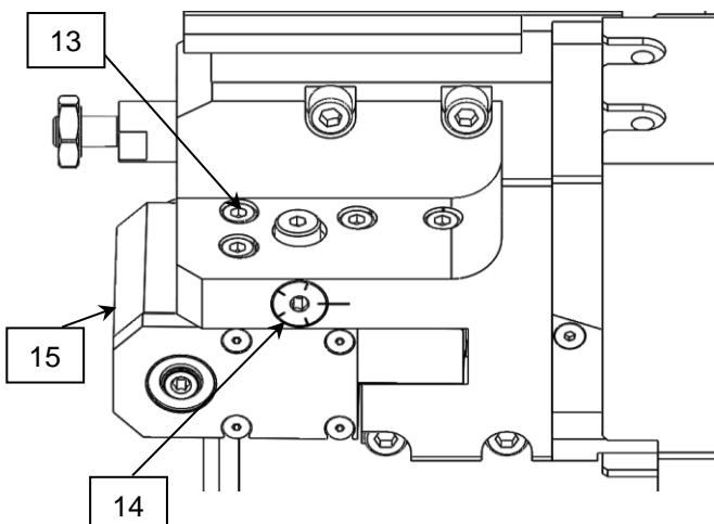
**Note 1 :** La vis de fixation [13] ne peut pas être montée sur la tôle d'origine [11]. Au besoin, repercer le trou de passage dans la tôle 11.5mm plus bas :
