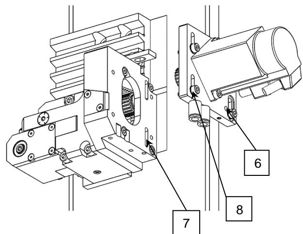
4. Um den Antriebsriemen zu spannen, benutzen Sie die Spannschraube [9] mit einem Drehmoment Schraubenzieher
