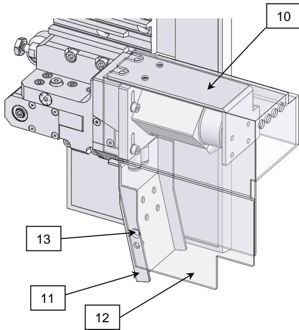
**Anmerkung 1:** Die Befestigungsschraube [13] passt auf dem originalen Blech [11] nicht. Wenn nötig, bohren Sie ein neues Loch auf 11.5mm unten:
