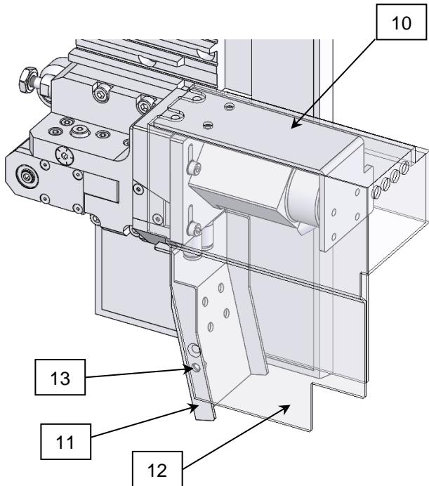
6. Pour régler l'inclinaison de la fraise, s'assurer que les 4 vis de blocage [13] sont desserrées, puis donner l'angle voulu à l'aide de la vis de réglage [14]. **Une division de vis = 0.2°**, 1 tour de vis = 1°. Pour une inclinaison précise, vérifier l'angle sur la face de référence [15]. Bloquer enfin les 4 vis [13].
