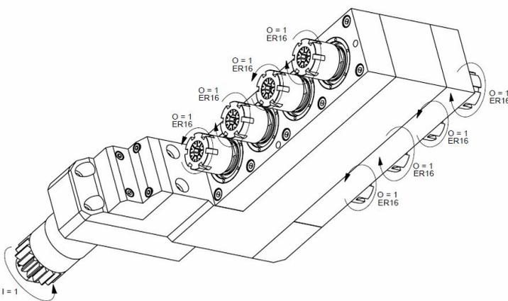
3. Lors du montage/démontage de vos outils, bloquer la broche à l'aide des plats prévus à cet effet, puis dévisser l'écrou en maintenant la broche. Attention à bloquer la broche du bon côté ! Si cette recommandation n'est pas suivie, les courroies de transmission risquent d'être endommagées ou même de céder.
