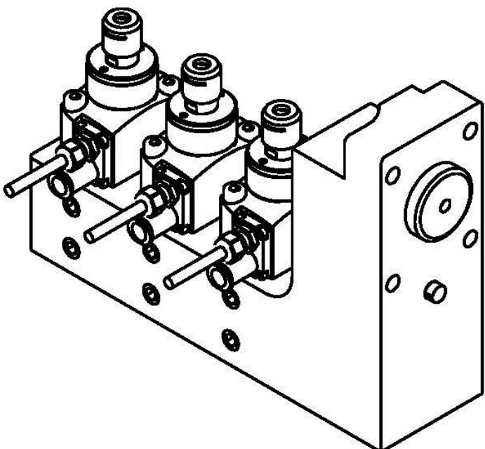
2. Serrer légèrement, les vis de fixation (important, veillez à ce que les vis aient la même force de serrage).
