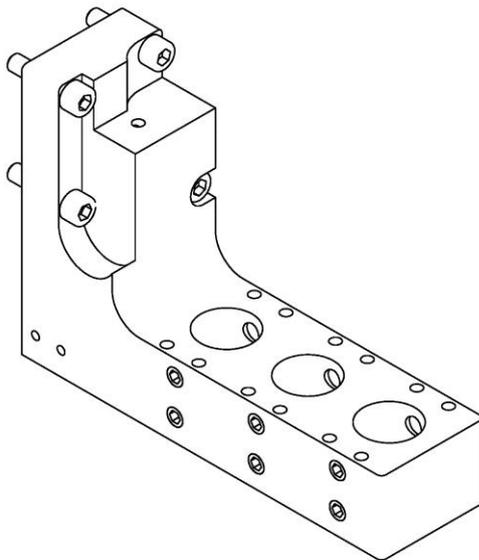
2. Ziehen Sie die Schrauben leicht an (Wichtig, beobachten Sie darauf, dass die Schrauben dieselbe Spannkraft haben).
